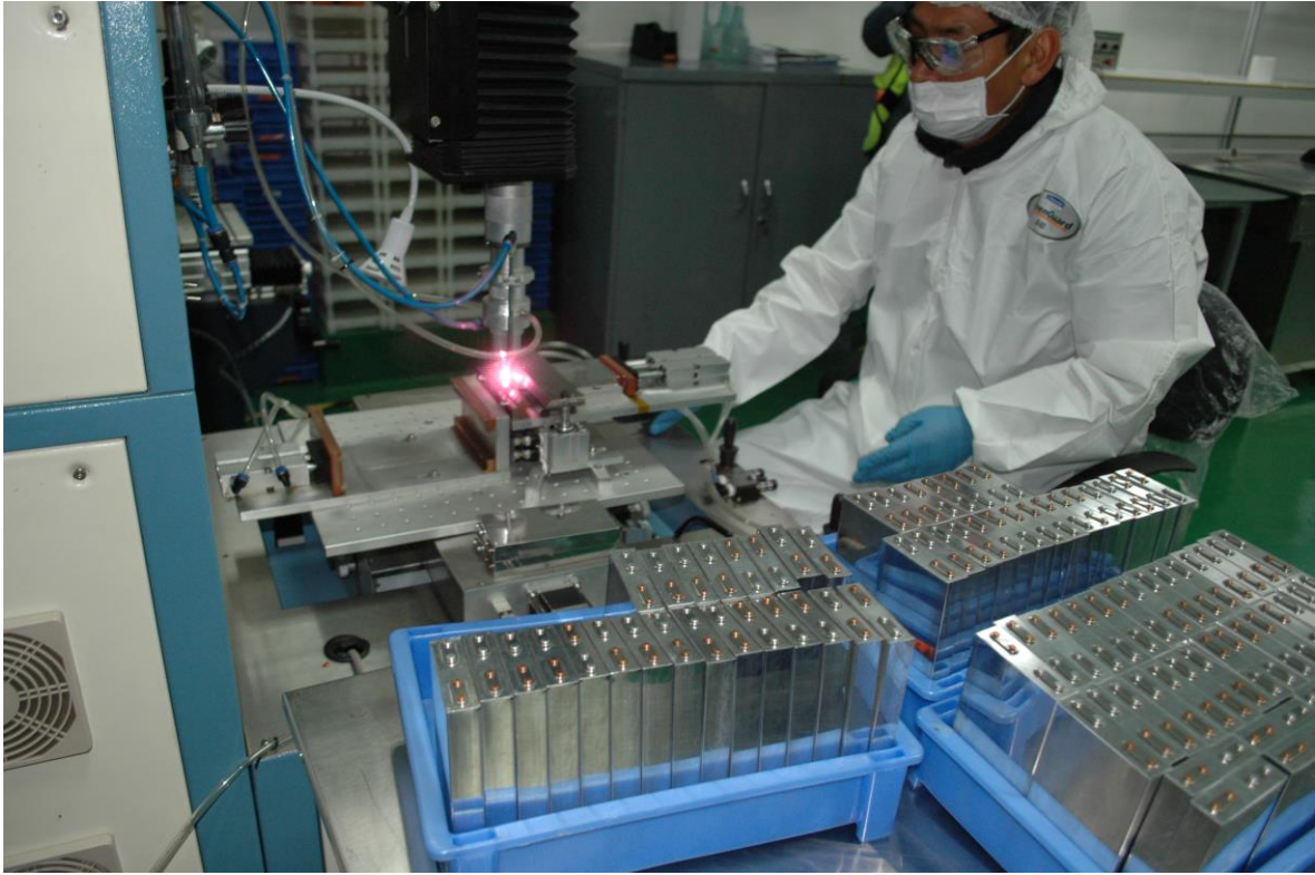
Sellado de baterías en Planta Piloto de baterías en La Palca-Potosí
