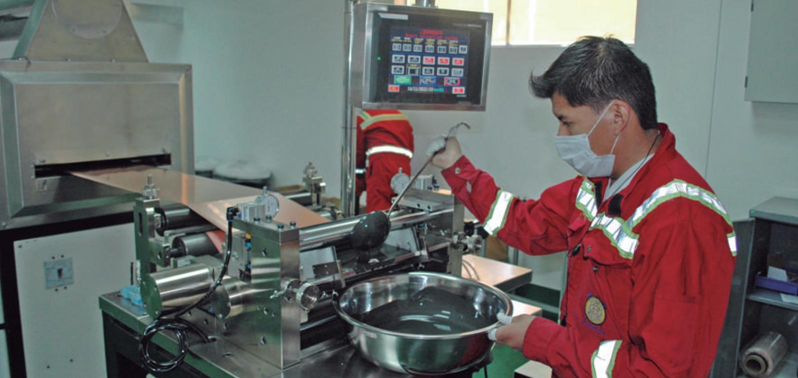
*Recubrimiento de material catódico sobre colector de corriente en Planta Piloto de baterías de Litio en La Palca - Potosí*
