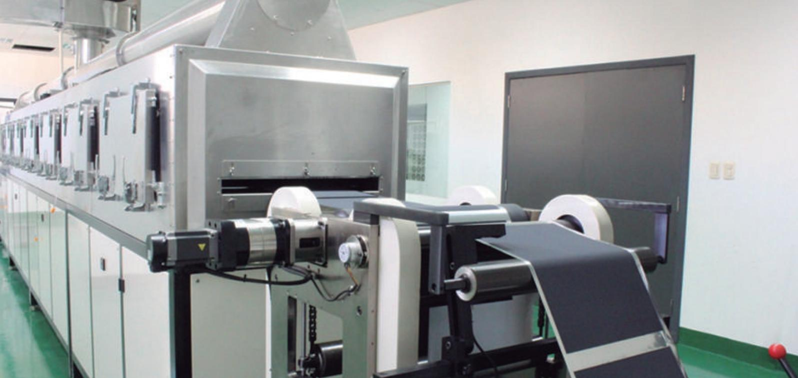
*Equipo de recubrimiento para el secado de materiales catódicos y anódicos a temperatura diferenciada.*
