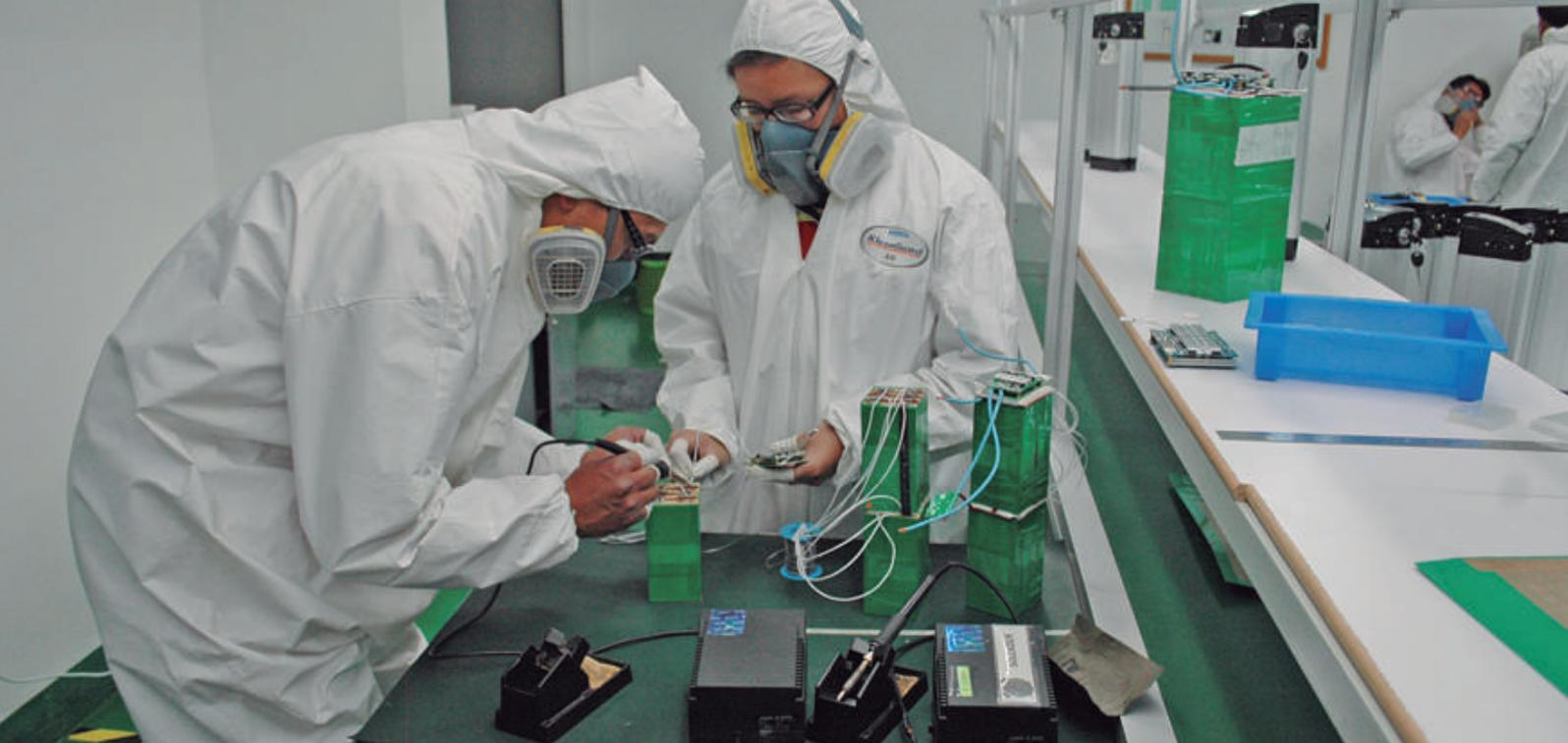
*Ensamblado experimental de baterías de Litio en Planta Piloto de La Palca - Potosí.*
