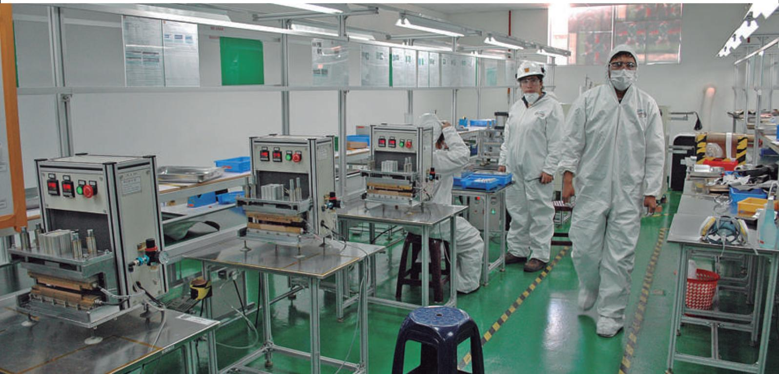
*Módulo de sellado de baterías de Litio de la Planta Piloto de baterías de Litio en La Palca - Potosí*
