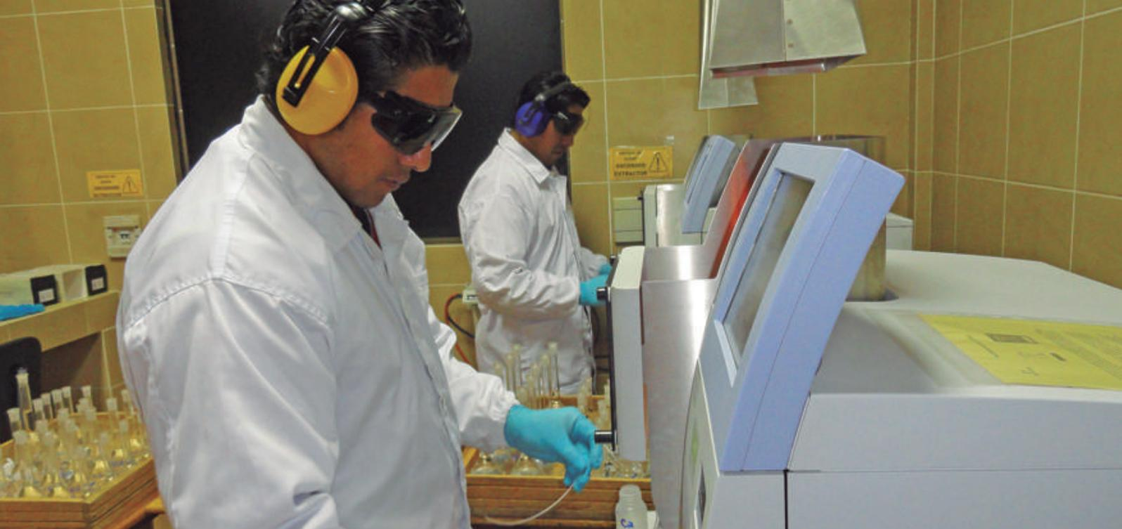
*Investigadores de la GNRE realizando sus tareas en equipos de adsorción atómica en laboratorio de Planta Llipi*
