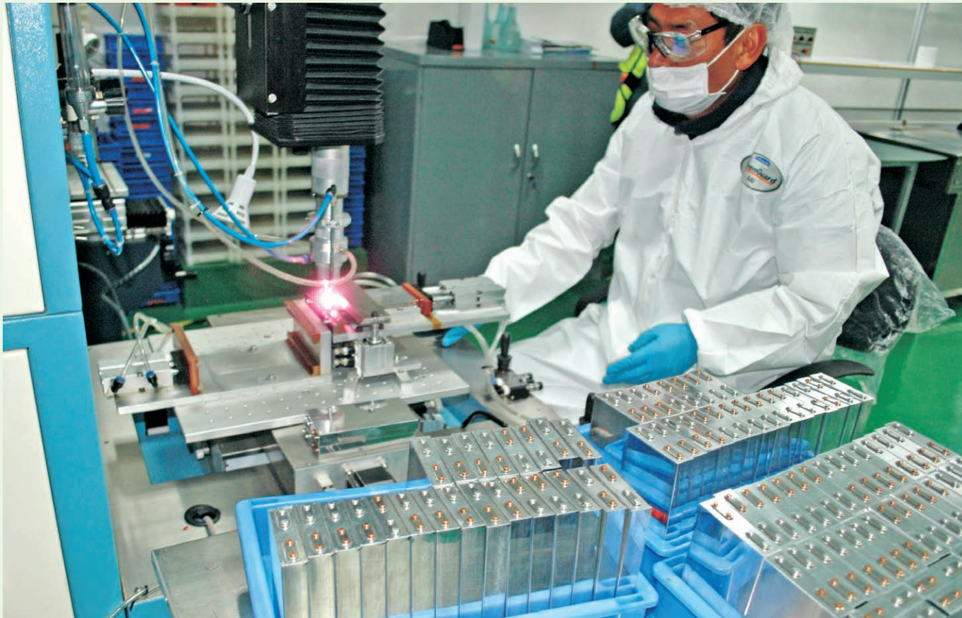
Módulo de prensado y sellado de baterías en Planta Piloto de La Palca
