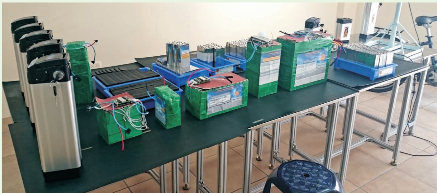
Ensamblado experimental de diferente configuración de celdas de baterías de Litio
