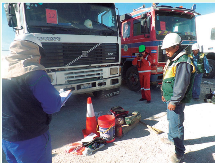
Inspección a volquetas, se observa el kit antiderrame, basurero, cono, extintor y otros implementos para contingencias
