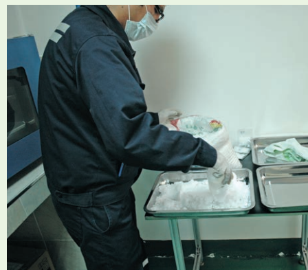
En la primera imagen, Hidróxido de Litio proceso en Planta Piloto de Llpi, en segunda imagen, condicionado de este material ( \text{LiOH}\cdot\text{H}_2\text{O} ) para su respectivo secado en laboratorio de Planta Piloto de baterías y CICYT-MAT REB
