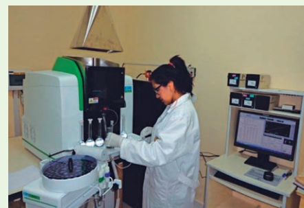
Técnico de la GNRE operando el equipo de absorción atómica
