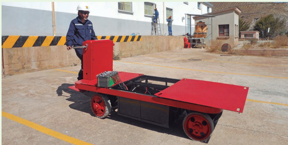
Transporta carga "Chapulín" condicionado con baterías de ion Litio
