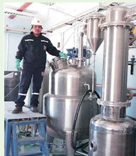
Técnico de la GNRE operando equipo cristizador al vacío
