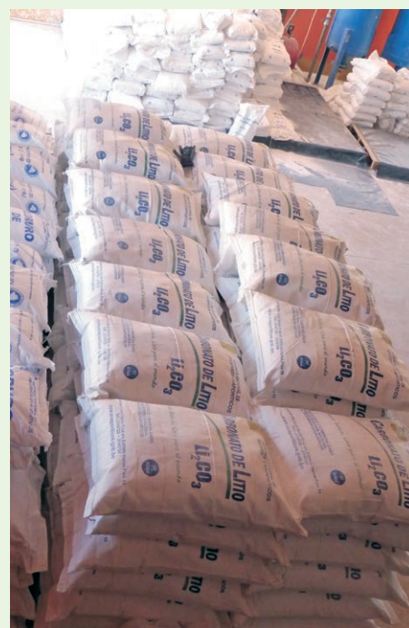
Carbonato de Litio en empaques de 15 kilogramos estocados en Planta Piloto de Llpi
