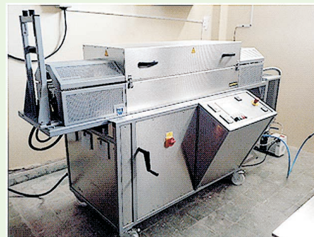
Horno rotatorio utilizado para el proceso de escalamiento en la síntesis de los cátodos \text{LiMn}_2\text{O}_4 y \text{LiFePO}_4
