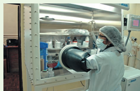
Técnico operando equipo Glove box con atmósfera controlada
