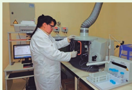
Técnico de la GNRE operando el espectrómetro de emisión óptica
