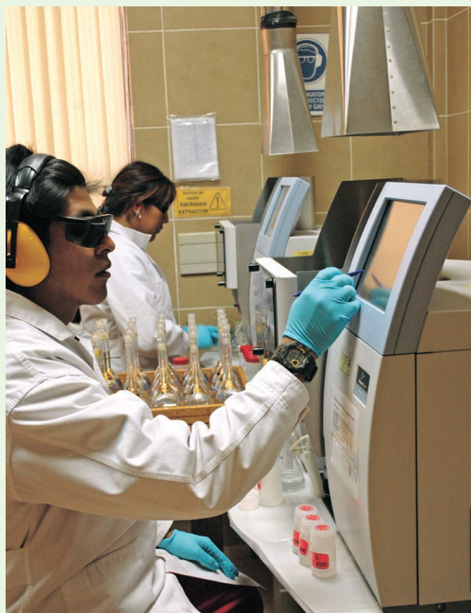
Cuantificación de elementos en equipos de absorción atómica
