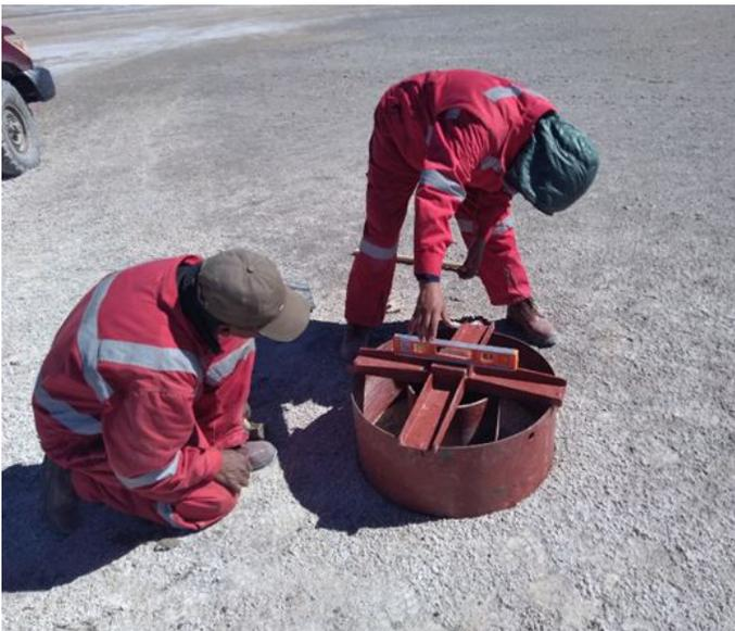
Prueba de conductividad hidráulica con anillas concéntricas
