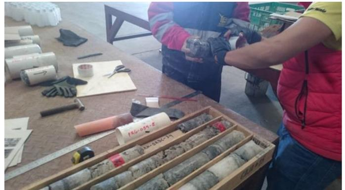
Muestreo y embalado de testigos de perforación para análisis de RBRC
