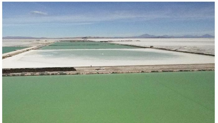
Este circuito inicialmente sirvió para realizar pruebas de bombeo y cortes en el proceso de evaporación, los resultados se los implementó en piscinas a nivel industrial, a la fecha continua la operación de estas piscinas aportando cristales para el procesamiento en las plantas.
