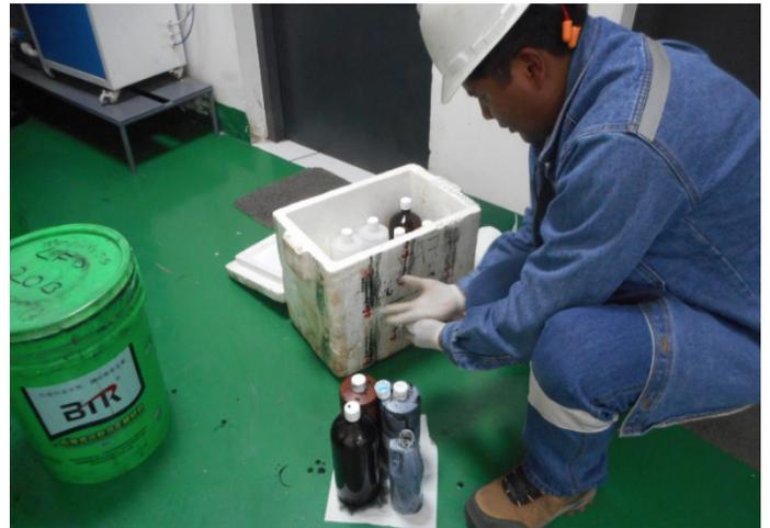
Toma de aguas residuales del lavado de utensilios y mezcladores de ánodo y cátodo en la Planta Piloto de Baterías - La Palca
