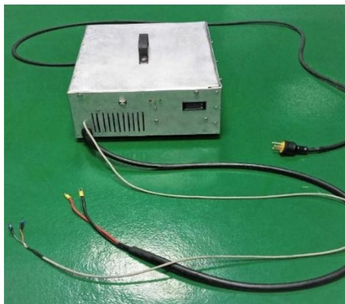
Cargador de batería de Ion-Litio on-board para vehículo eléctrico desarrollado por técnicos de YLB
