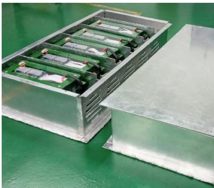
Pack de batería ensamblada por técnicos de la PPB-YLB
