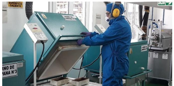
Técnico de la PPMC colocando los crisoles con mezcla de precursores para proceso de calcinación en los hornos
