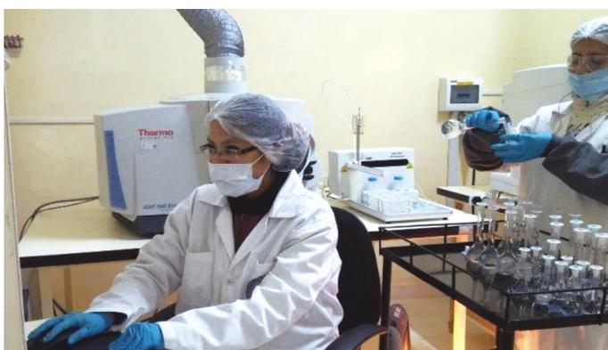
*Servicio de Laboratorio de Análisis Químico con el equipo Espectrómetro de emisión óptica acoplado inductivamente con plasma "ICP-OES" (YLB, La Palca)*
