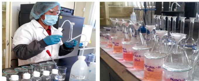
*Preparación de muestras para análisis instrumental por AAS o ICP-OES, o para la realización del ensayo mediante métodos clásicos en el Laboratorio de Análisis Químico (YLB, La Palca)*
