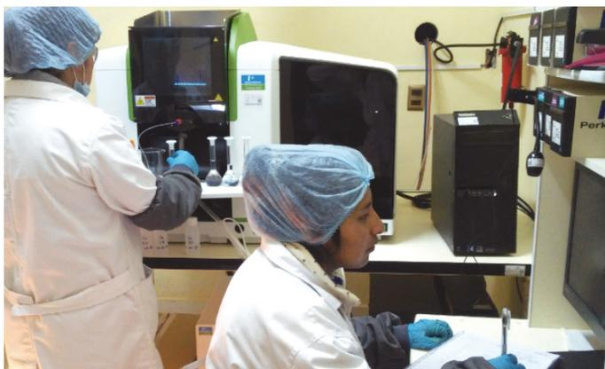
*Servicio del Laboratorio de Análisis Químico con el equipo Espectrómetro de Absorción Atómica "AAS" (YLB, La Palca)*
