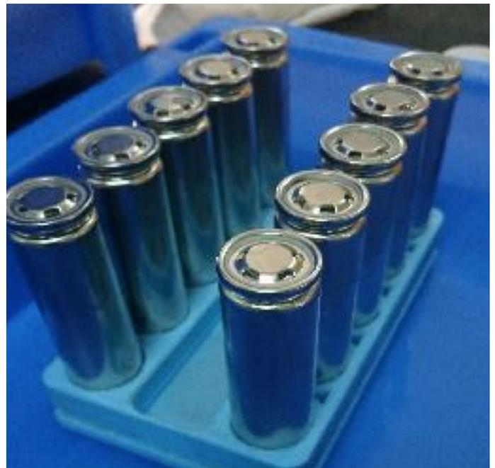
Baterías cilíndricas ensambladas en la PPB
