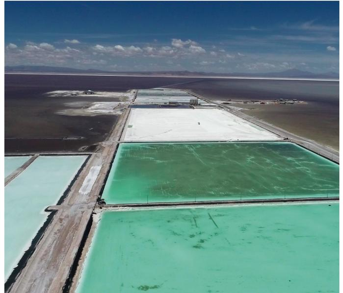
Piscinas de evaporación en serie escala semi industrial - circuito Acoplamiento
