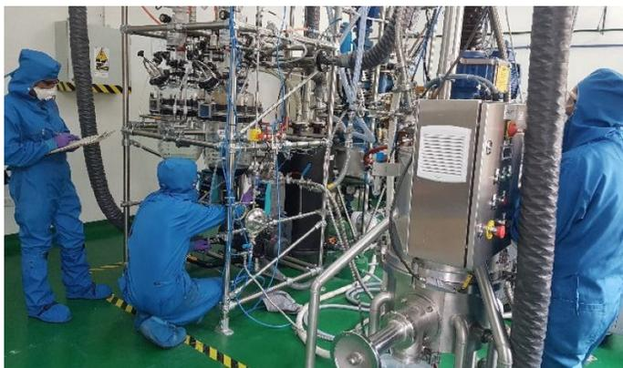
Proceso de obtención de NMC en el Coprecipitador
