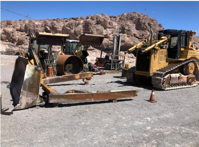
*Desmontado de bulldozer de tractor de orugas para reacondicionado de muñón central*
