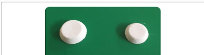
Figura 20. Materiales NASICON en el sistema  $Li_{(1+2x)}Sn_{(2-x)}Mg_x(PO_4)_3$  con  $x = 0.15$  y  $0.10$ .
