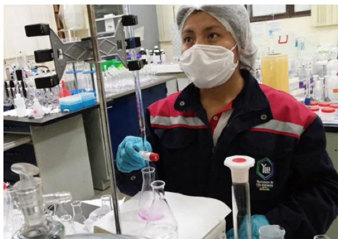
*Figura 4. Analista de laboratorio realizando el ensayo de carbonatos en muestras de carbonato de litio durante el ensayo de aptitud (YLB, La Palca)*
