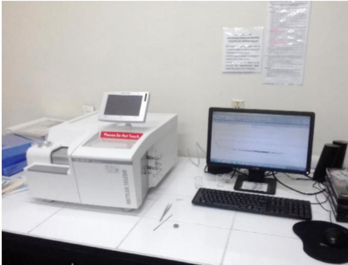
Figura 10. Equipo analizador simultáneo termogravimétrico calorimétrico ATG/DSC
