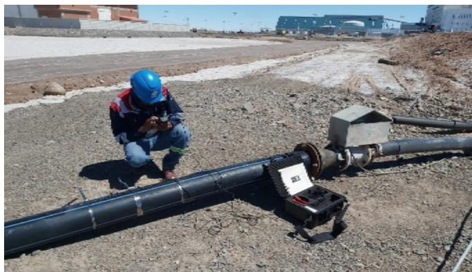
Medición del caudal de agua dulce, con equipo ultrasónico en piscina pulmón cercano a la planta KCl.
