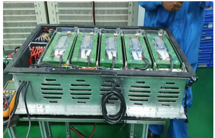
Figura 29: Pack de baterías de ion litio (64V/50 Ah) de YLB para vehículos eléctricos
