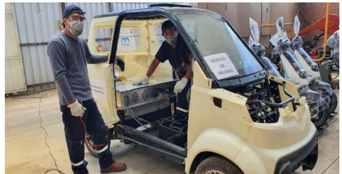
Figura 30: Montado del pack de batería (64 V/50 Ah) en vehículo eléctrico de Quantum
