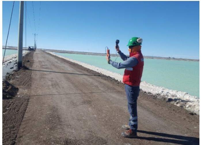
Monitoreo de condiciones climáticas medición de velocidad de viento mediante anemómetro
