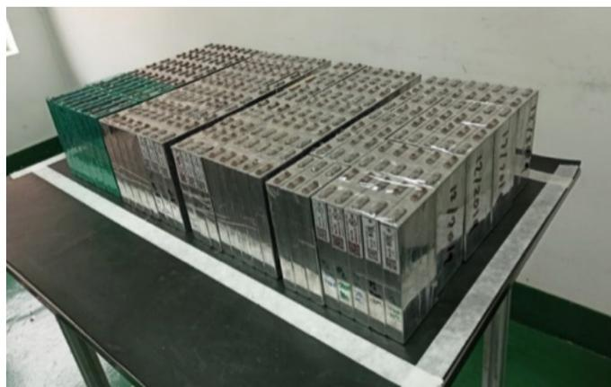
*Figura 33: Desarrollo del paquete de batería de ion litio(64V/80Ah) para vehículo eléctrico*
