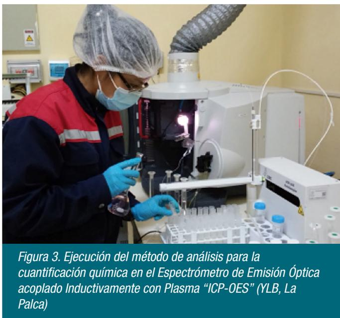
*Figura 3. Ejecución del método de análisis para la cuantificación química en el Espectrómetro de Emisión Óptica acoplado Inductivamente con Plasma "ICP-OES" (YLB, La Palca)*
