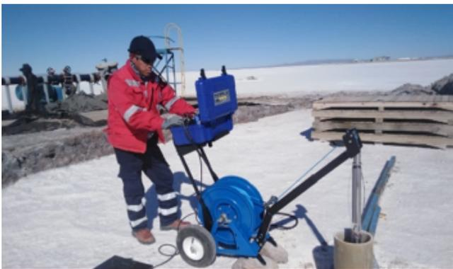
Figura 8. Trabajo de endoscopia de pozo productor de salmuera.
