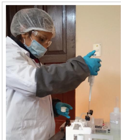
Figura 2. Dispensación de volúmenes precisos con micropipeta durante la preparación de estándares de calibración para análisis químico en el Espectrómetro de Absorción Atómica "AAS" (YLB, La Palca).
