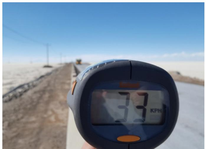
Control de velocidad en terraplén empleando un radar de velocidad.
