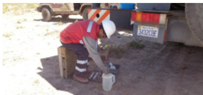
Figura 4. Lectura de los parámetros físico-químicos in situ de las aguas subterráneas para la evaluación de la calidad de las aguas.
