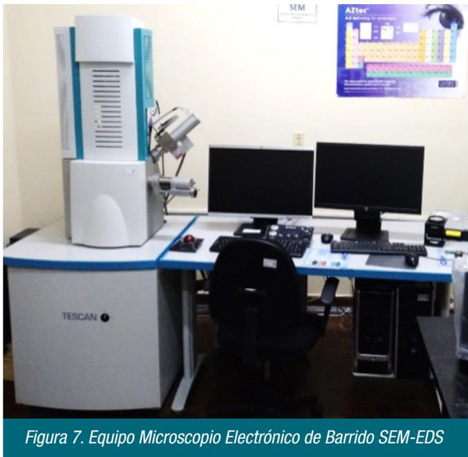
Figura 7. Equipo Microscopio Electrónico de Barrido SEM-EDS
